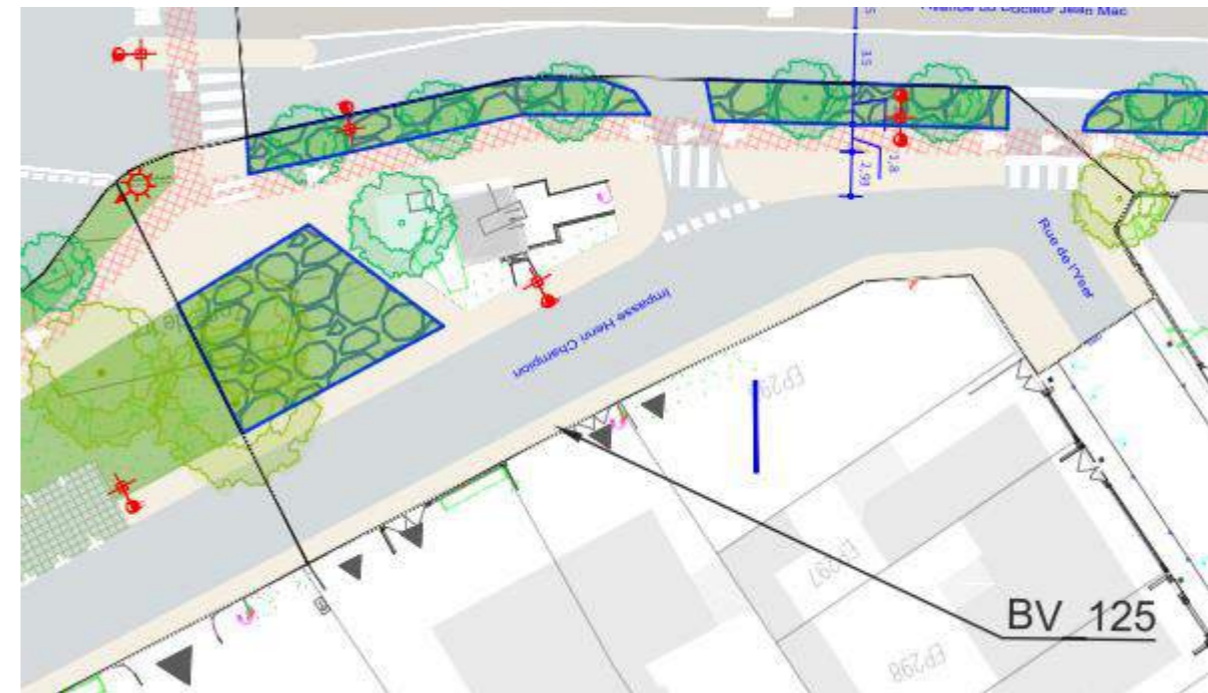
Espaces verts en creux et massifs drainants. Le volume de rétention disponible est de : 60 m 3
