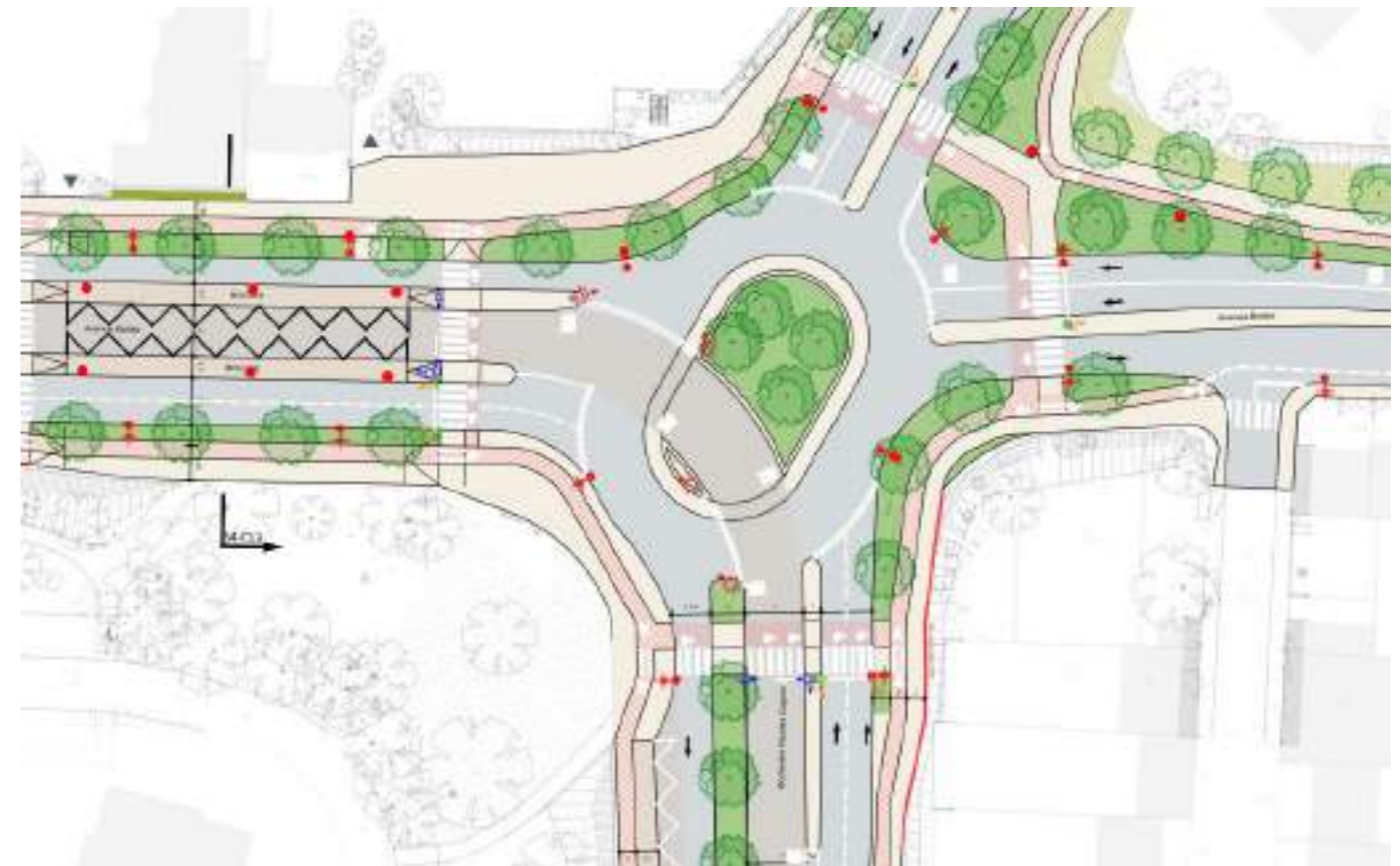
Figure 45 : Insertion du giratoire des 4 pentes
